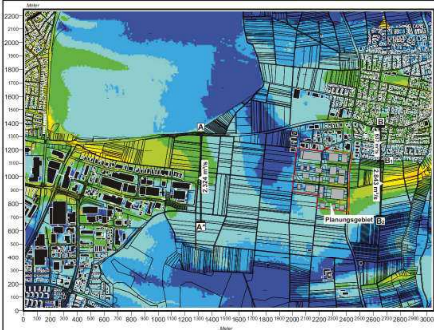
Abb. 18.3 Plan-Zustand, Ergebnis mesoskaliger Kaltluftströmungssimulationen mit östlicher Regionalströmung (0.5 m/s) Kaltluftvolumenstrom, 2 Std. nach einsetzender Kaltluftbildung
