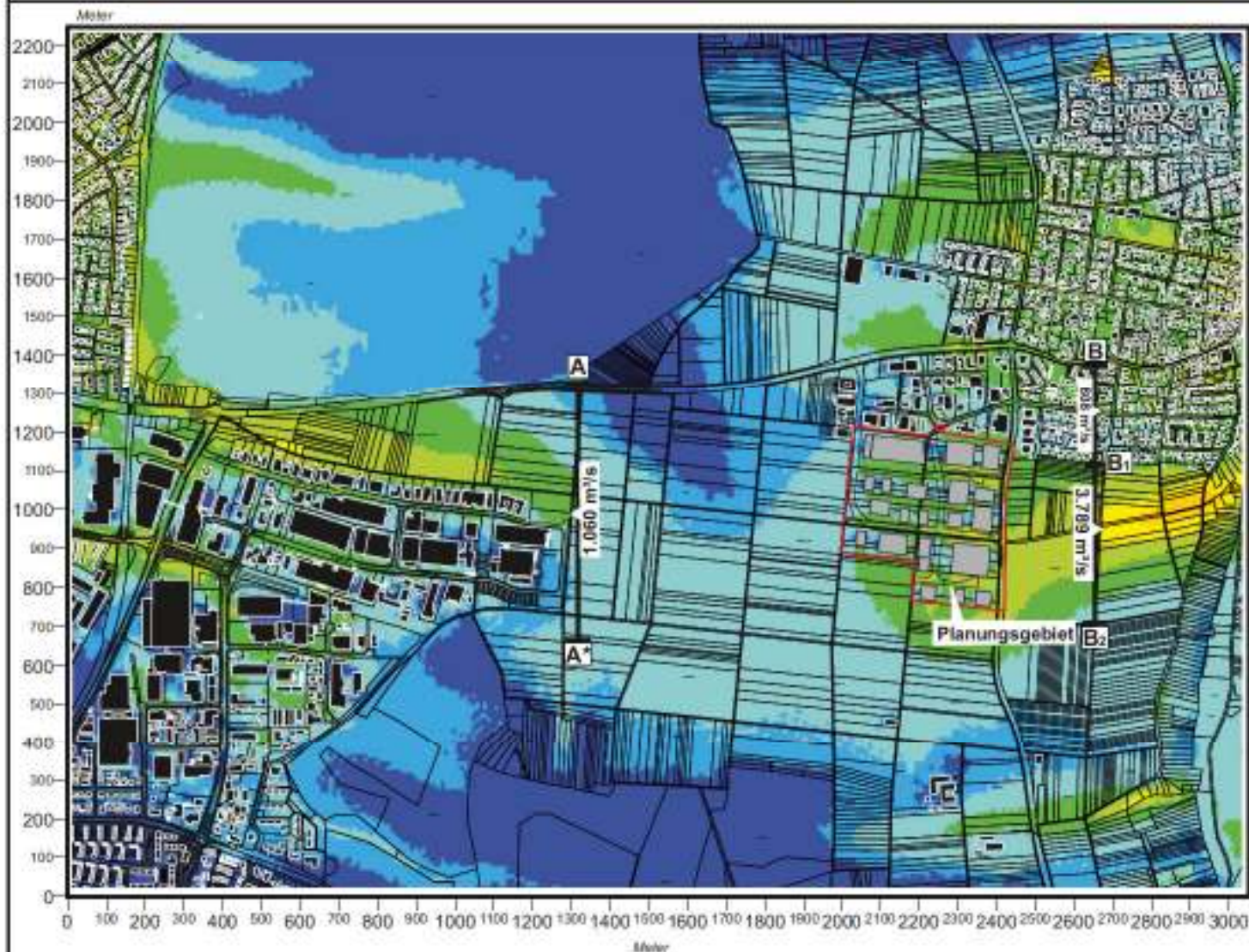
Abb. 24.3 Plan-Zustand, Ergebnis mesoskaliger Kaltluftströmungssimulationen mit westlicher Regionalströmung (0.5 m/s) Kaltluftvolumenstrom, 2 Std. nach einsetzender Kaltluftbildung
