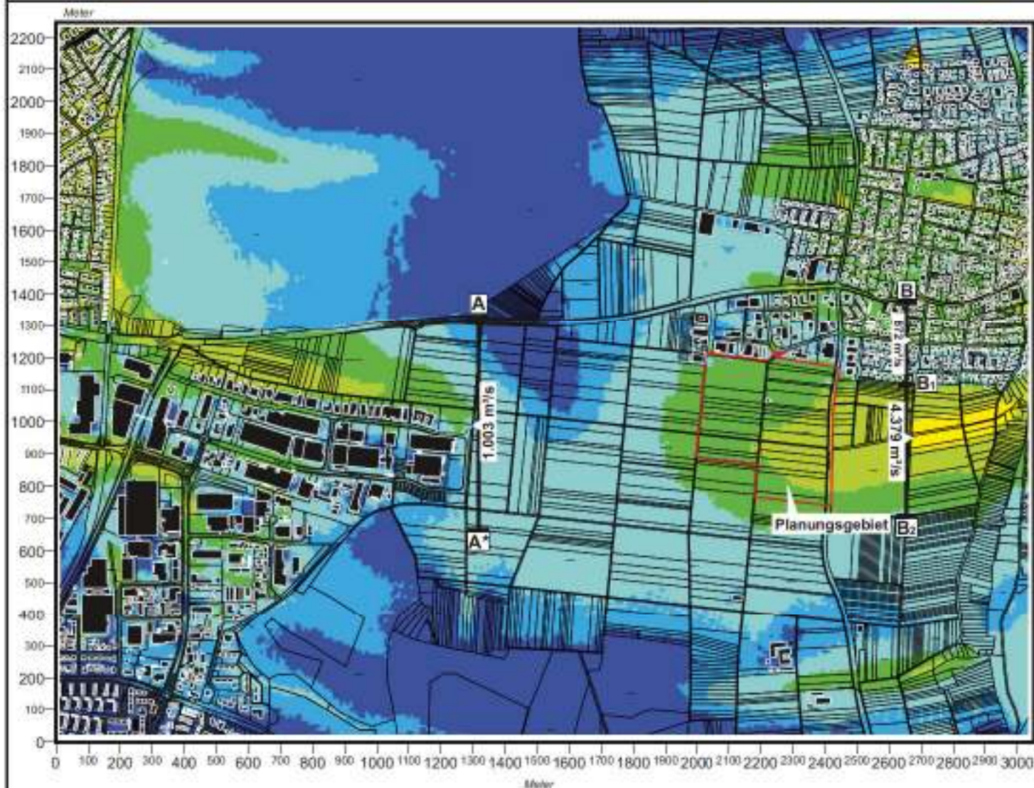
Abb. 23.3 Ist-Zustand, Ergebnis mesoskaliger Kaltluftströmungssimulationen mit westlicher Regionalströmung (0.5 m/s) Kaltluftvolumenstrom, 6 Std. nach einsetzender Kaltluftbildung
