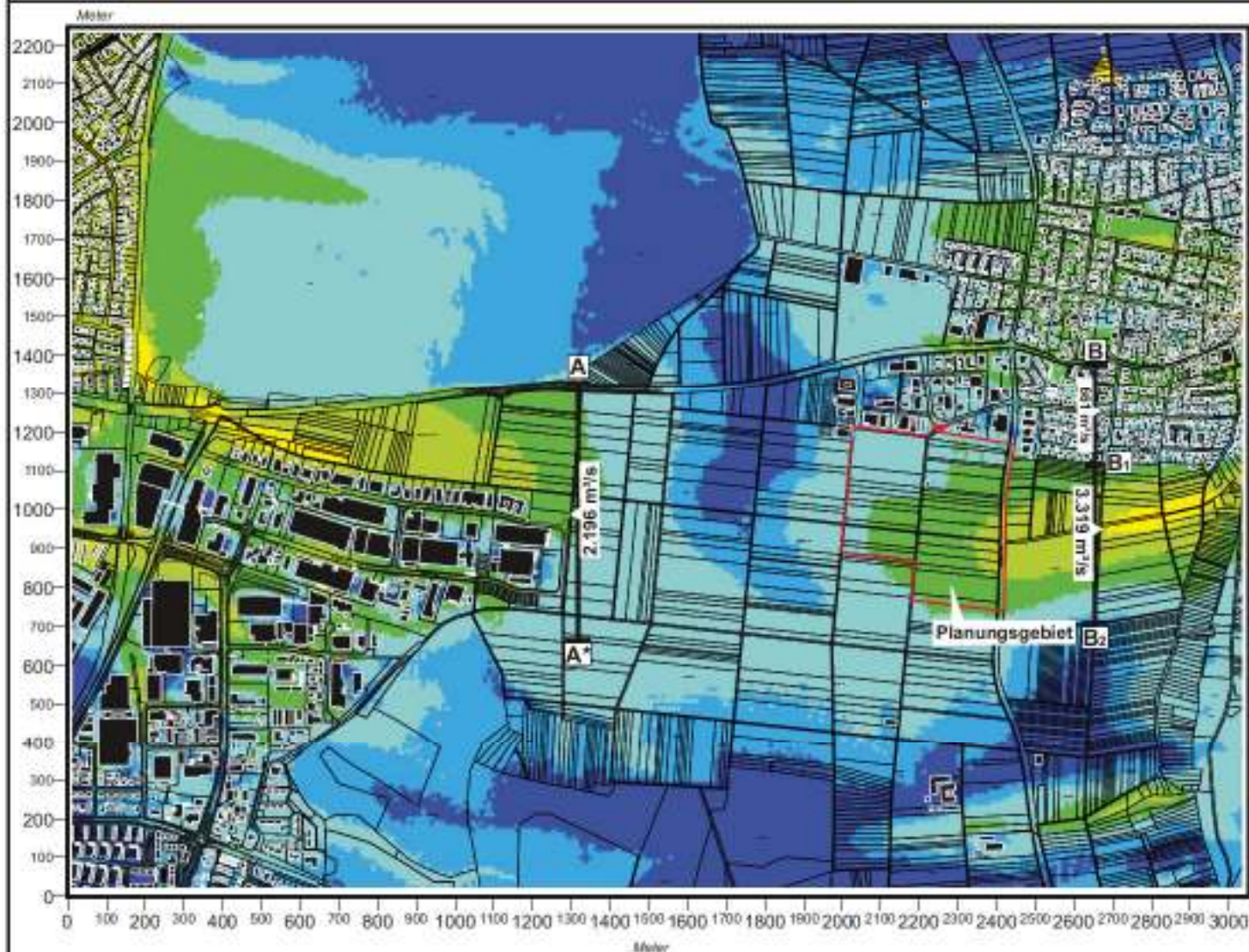
Abb. 17.3 Ist-Zustand, Ergebnis mesoskaliger Kaltluftströmungssimulationen mit östlicher Regionalströmung (0.5 m/s) Kaltluftvolumenstrom, 6 Std. nach einsetzender Kaltluftbildung
