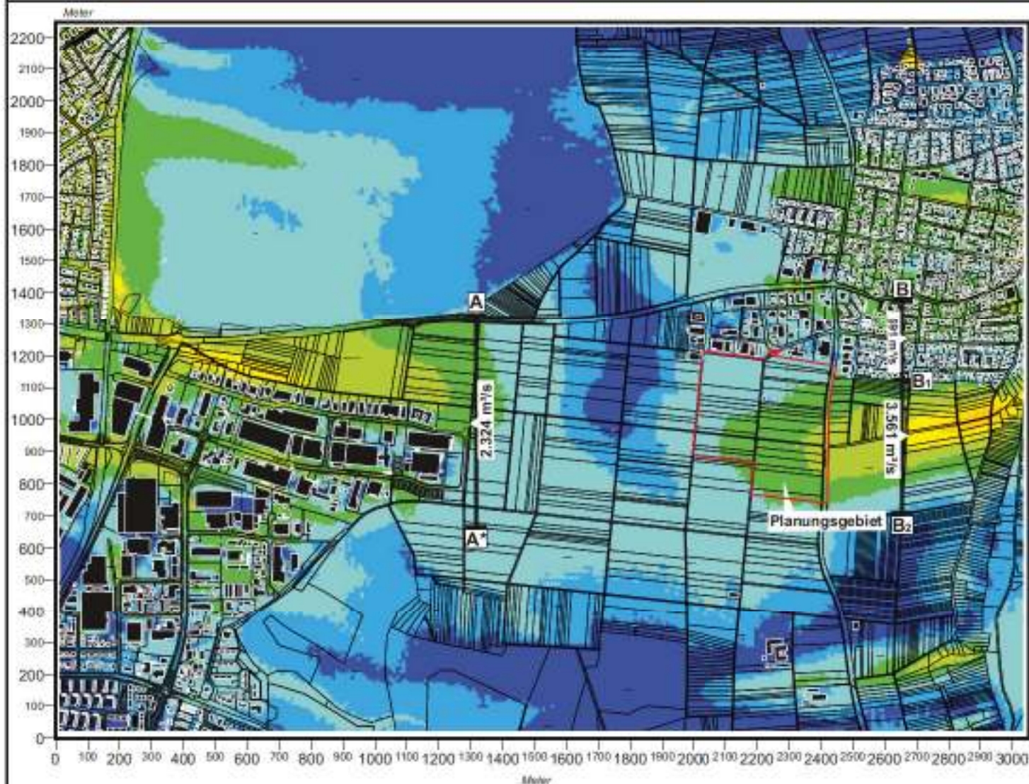
Abb. 16.3 Ist-Zustand, Ergebnis mesoskaliger Kaltluftströmungssimulationen mit östlicher Regionalströmung (0.5 m/s) Kaltluftvolumenstrom, 2 Std. nach einsetzender Kaltluftbildung
