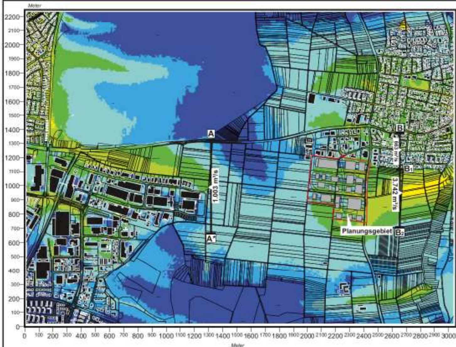
Abb. 26.3 Plan-Zustand, Ergebnis mesoskaliger Kaltluftströmungssimulationen mit westlicher Regionalströmung (0.5 m/s) Kaltluftvolumenstrom, 6 Std. nach einsetzender Kaltluftbildung
